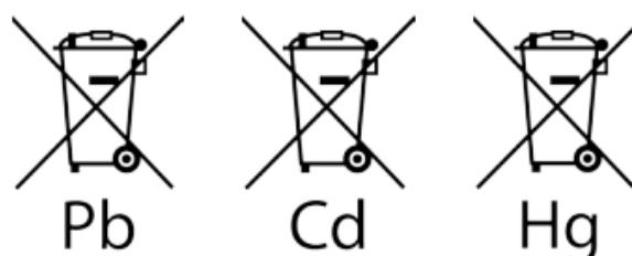
Эта маркировка означает, что батареи и аккумуляторы содержат тяжелый металл, обозначенный в виде символа химического элемента. Указанные символы обозначают, в частности:
